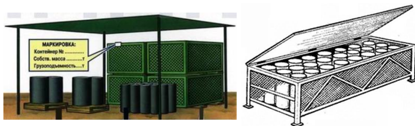
Рис. 4.12. Схема зберігання рулонних матеріалів
