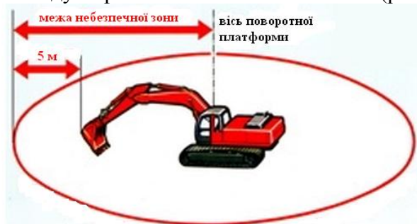
Рис. 1.5. Межа небезпечної зони роботи машин, що мають рухомі робочі органи
