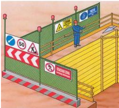
Рис. 2.6. Огородження виїмок в місцях, де відбувається рух людей і транспорту
