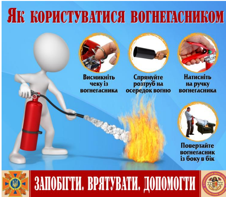
Рис. 4. Правила використання вогнегасника
