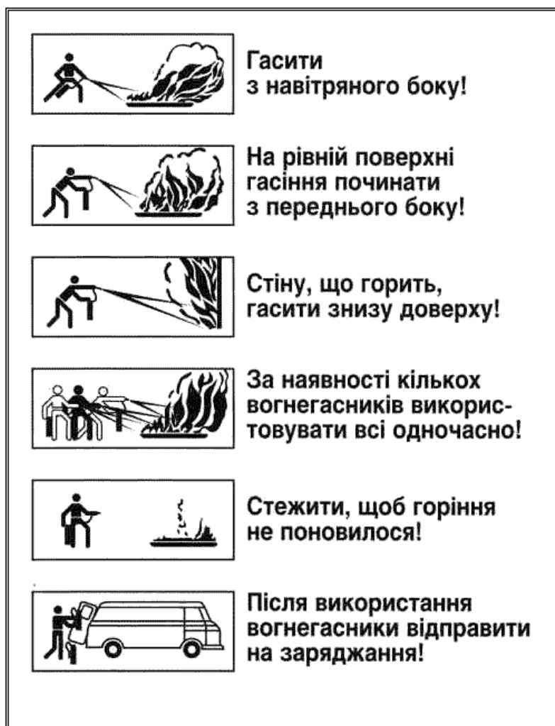
Рис. 5. Порядок використання вогнегасників
