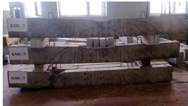
Рис. 6. Характер руйнування дослідних балок серії БМС-7 з гібридним армуванням 2\text{Æ}14 АКС800 і \text{Æ}12 А400С розтягнутої зони
