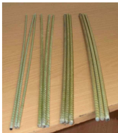
Рис. 2. Дослідні зразки склопластикової арматури АКС 800 \text{Æ}8 , 10, 12 і 14 мм
