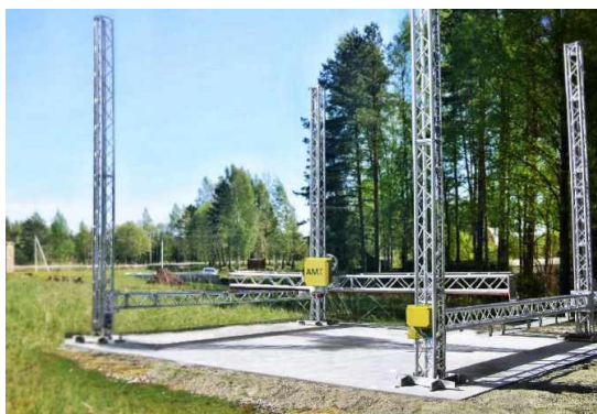
Рис.11. Будівельний 3D-принтер порталного типу "АМТ" S-300
