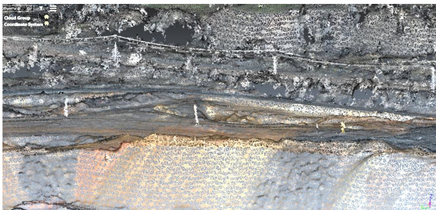
Рис. 5. Стовпи і дроти на цифровій моделі побудованій системою Pix4d
