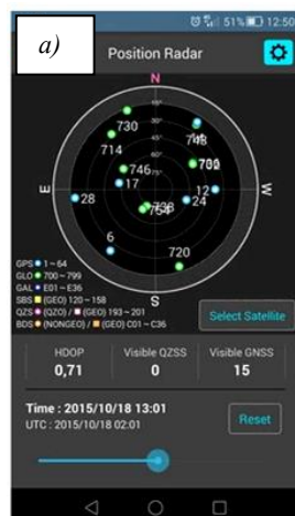
Рис. 7. Робочі вікна розміщення супутників: а – стан супутників для кута відсічення 15°; б – стан супутників для кута відсічення 55°
