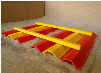
Рис.3. Моделі конструкцій фундаменту з пластику у зібраному вигляді: а – модель прототипної конструкції складчастого фундаменту; б – модель оптимальної конструкції складчастого фундаменту
