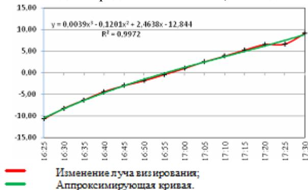
Рис. 1. Изменения луча визирования по оси аппликата с течением времени, мм
