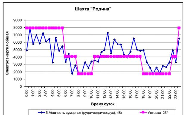
Рисунок 8 – Результаты трехканальной («Руда-Вода-Воздух») оптимизации суммарного потреблением ЭЭ на основе рациональной уставки («Уставка123\*»)
