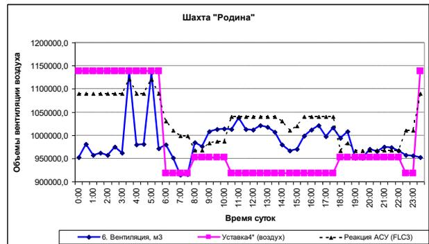
Рисунок 7 – Моделирование минимаксного подхода к оптимизации по каналу «Воздух» («Вентиляция воздуха»)
