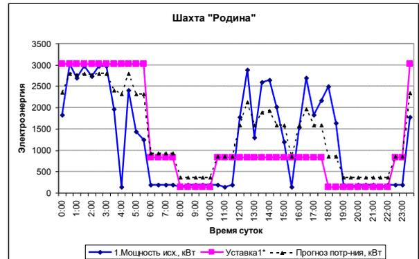
Рисунок 6 – Зависимости потребляемой мощности активной электроэнергии (1) до и после оптимизации (уставка 1\*), а также прогноза энергопотребления при условии критерия (1)
