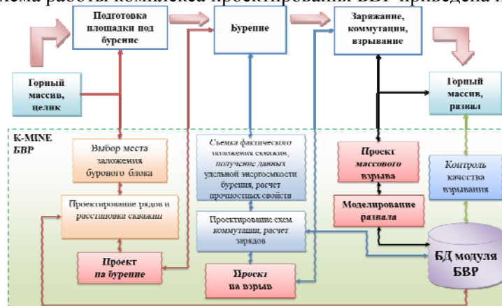
Рис. 1. Структурная схема работы системы проектирования и управления буровзрывными работами с применением K-MINE
