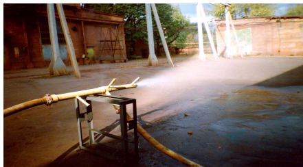
Рис. 2. Испытание охлаждающего эжектора на промплощадке шахты им. Ленина
