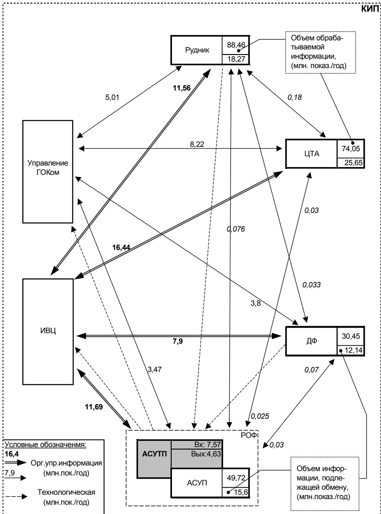
Рисунок 1 - Схема информационных потоков в АСУТП и КИП ИнГОКа (ИВЦ - информационно - вычислительный центр; ЦТА - цех технологического автотранспорта; ДФ - дробильная фабрика; РОФ - рудообогатительная фабрика)
