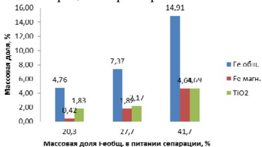
**Рис. 4.** Зависимость показателей не магнитного продукта сухой магнитной сепарации (хвостов) при разной массовой доли ценных компонентов в исходном питании
