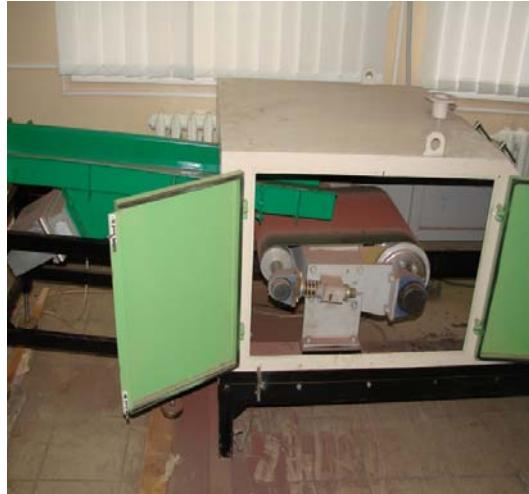
Рис. 1. Магнитные сепараторы: BC-31,5/30-H; 1PC-22/30-P
