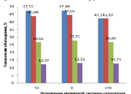
**Рис. 2.** Качественные показатели магнитного продукта сепарации при разных углах наклона магнитной системы
