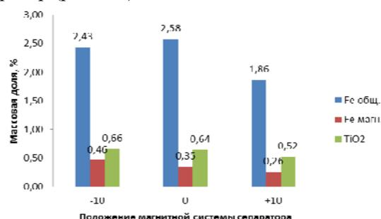
**Рис. 3.** Качественные показатели немагнитного продукта сепарации при разных углах наклона магнитной системы
