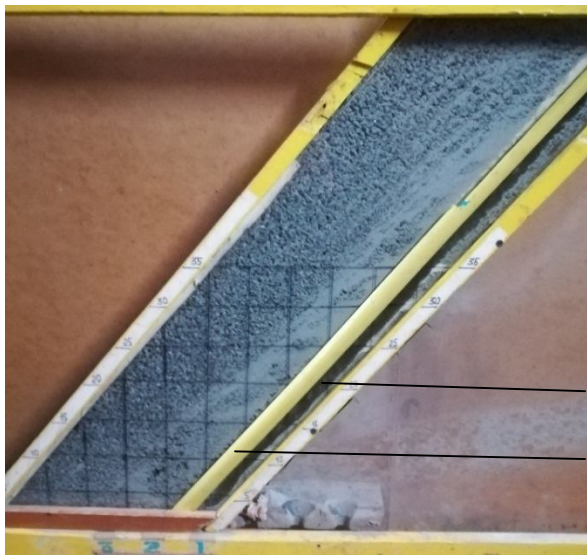
Рис.5. Стадії випуску похилого потоку першого шару відбитої руди із похилої щілини (камери) під прикриттям непорушеного рудного масиву: 1 – похила щілина; 2 – непорушений рудний масив
