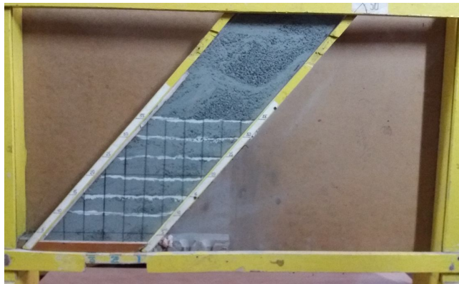
Рис.2. Лабораторна модель для дослідження випуску відбитої руди
