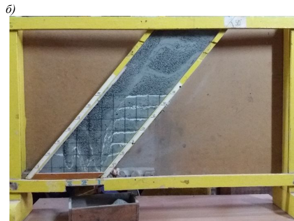
Рис. 3. Фізична картина результатів моделювання на проміжній (а) та кінцевій (б) стадіях класичної технології випуску відбитої руди
