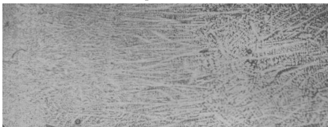
Рис. 2. Прерывистость роста столбчатых дендритов верхнего горизонта опытного слитка, вызванная виброобработкой, ×2,5
