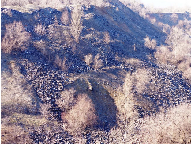
Рис. 2. Воронка в основании уступа временного склада окисленных руд ПАО «АрселорМиттал Кривой Рог»
