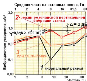
Рис. 4. Экспериментальные спектры вертикальных резонансных колебаний рамы бурового станка СБШ-250-32А при различных режимах работы
