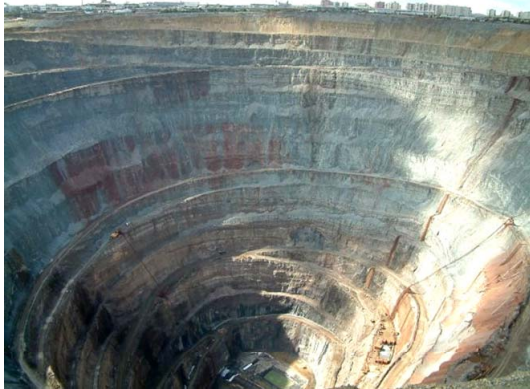
Рис. 1. Добыча алмазов в Якутии карьером с крутыми результирующими углами
