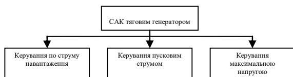
Рис. 2. Функції системи автоматичного керування тяговим генератором
