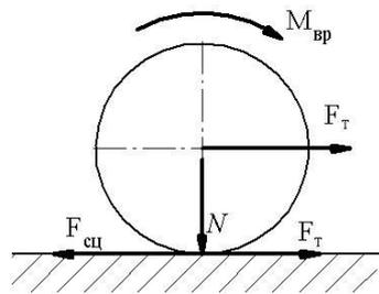
Рис. 1. Упрощенная модель создания силы сцепления
