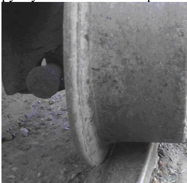
Рис. 1. Руйнування провусини кріплення колісної вісі
