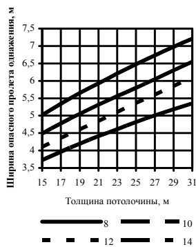
Рис. 2. Зависимость изменения ширины опасного пролета обнажения от толщины потолочины и коэффициента крепости пород
