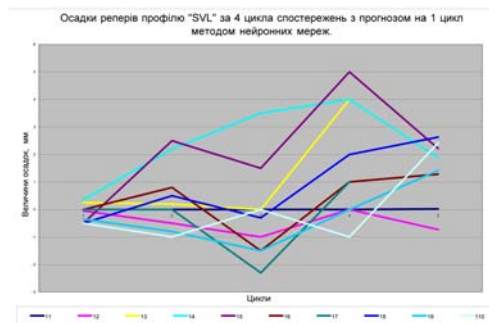
Рис. 4. Осадки реперів профілю "SVL" за 4 цикли спостережень з прогнозом на 1 цикл методом нейронних мереж
