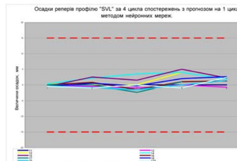
Рис. 5. Осадки реперів профілю "SVL" за 4 цикли спостережень з прогнозом на 1 цикл методом нейронних мереж з відображенням значень осадок, які характеризують зону впливу підземних гірничих робіт
