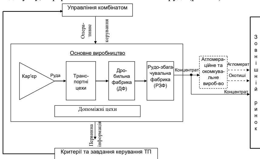
Рис. 1.1. Узагальнена схема процесу видобутку та переробки (збагачення) залізної руди в умовах ГЗК
