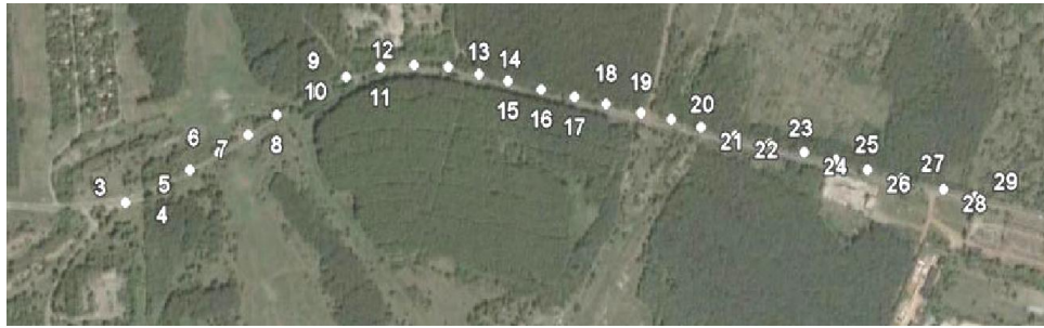
Рис. 1. Схема размещения реперов станции наблюдения на космическом снимке [1]
