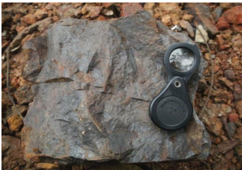
Рис. 1. Линзовидные и гнездообразные тела богатых руд (темнокоричневое) среди выветренных сланцев и силикатных кварцитов.
