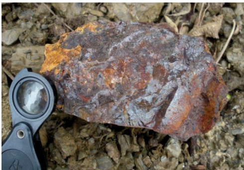
Рис. 2. Характерные текстуры коренных богатых руд. а – массивная с проявлением трещиноватости; б – пятнисто-кавернозная; в – пятнисто-прожилковая; г – пятнисто-землистая.
