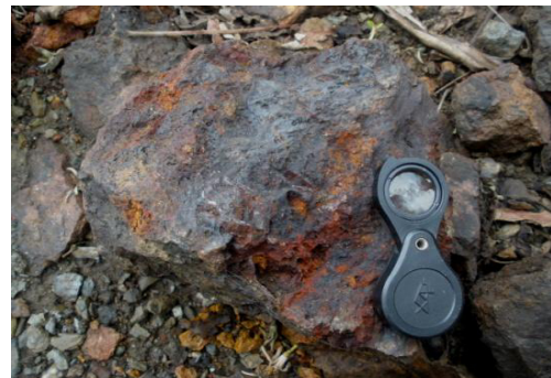
Рис. 1. Линзовидные и гнездообразные тела богатых руд (темнокоричневое) среди выветренных сланцев и силикатных кварцитов.
