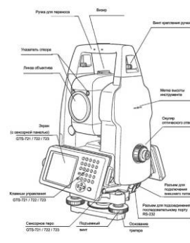
Рис. 2. Конструктивні елементи приладу Topcon-7001
