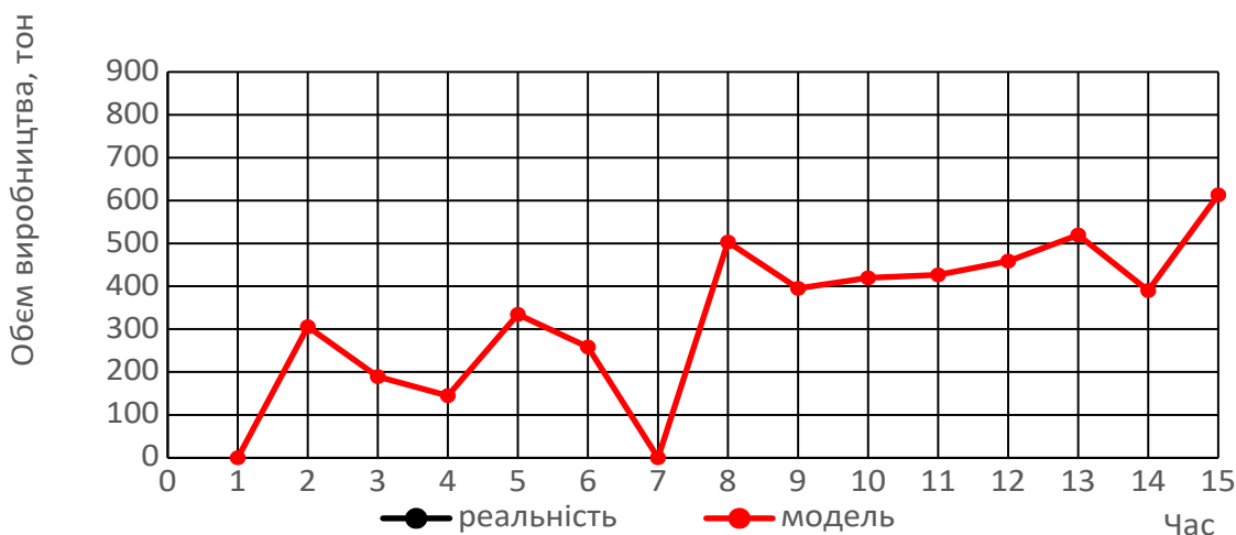
Рисунок 3.19 – Графік залежності обсягів виробництва і його моделі від часу шахти №11 на ДПП (2 трансформатор)
