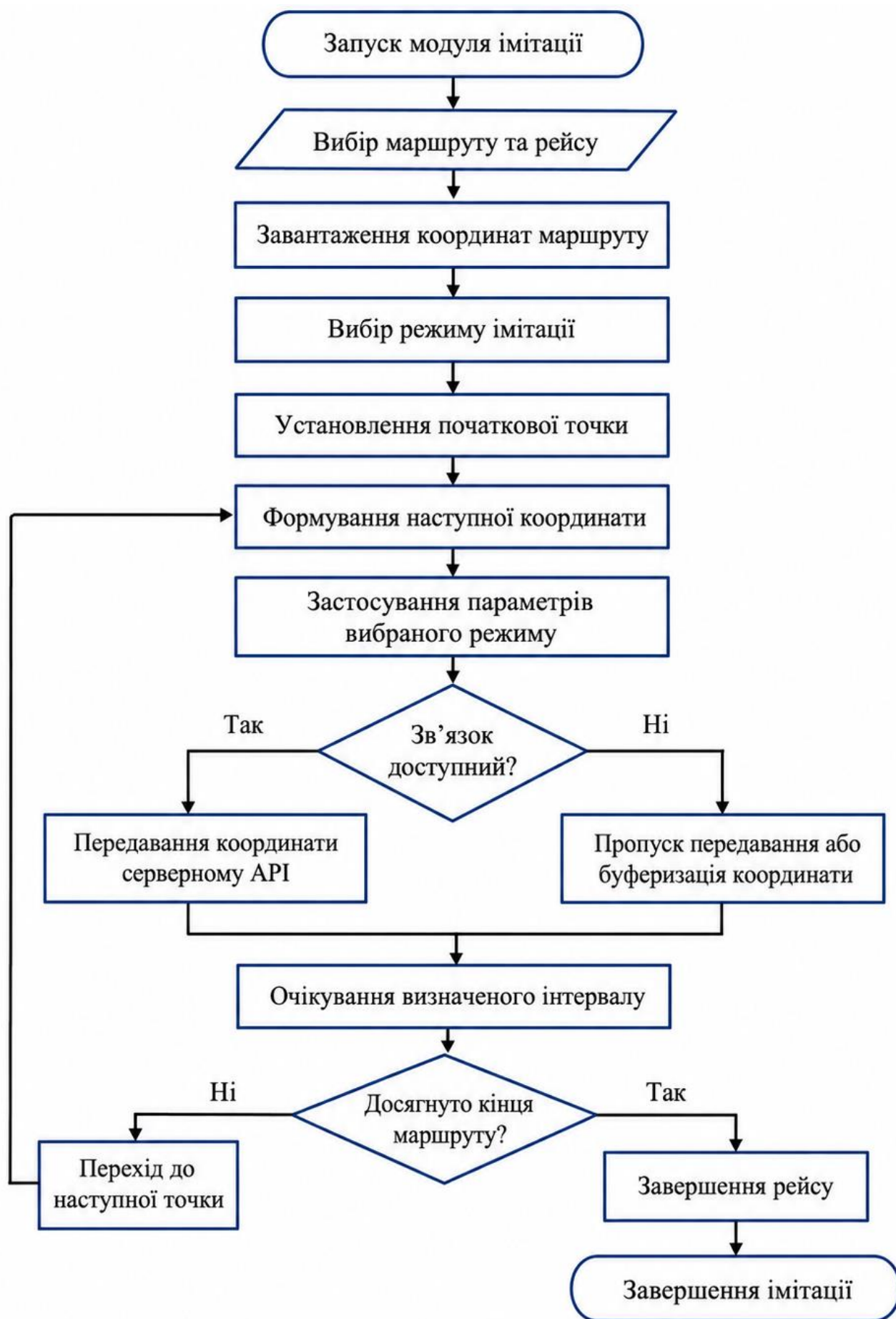
Рисунок 2.6 – Алгоритм імітації руху транспортного засобу
