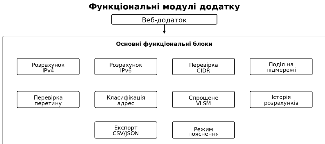
Рисунок 2.2 – Функціональні модулі додатку Основні модулі backend-частини наведено у таблиці 2.7.
