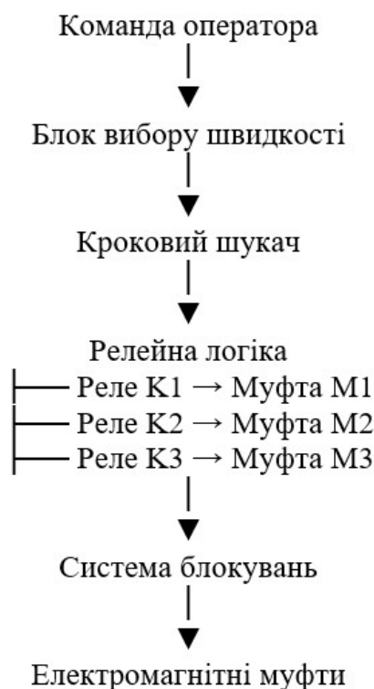
Рисунок 1.3- Функціональна схема керування муфтами
