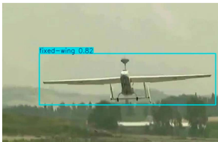
Рисунок 2.31 – Захід на посадку БПЛА (класифікація: fixed-wing 0.82)
