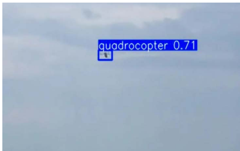
Рисунок 2.32 – Помилкове визначення класу БПЛА літакового типу як клас квадрокоптер (quadrocopter 0.71)
