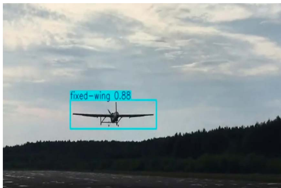
Рисунок 2.30 – Розгін та зліт БПЛА (класифікація: fixed-wing 0.88)
