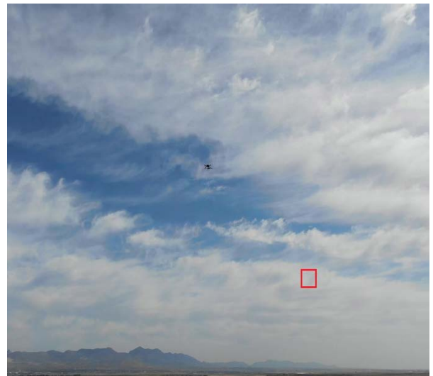
Рисунок 2.7 – Невідповідність Bounding Box з фактичним розташуванням БПЛА
