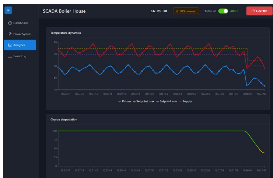
Рисунок 2.44— Аналіз ефективності алгоритму збереження енергії
