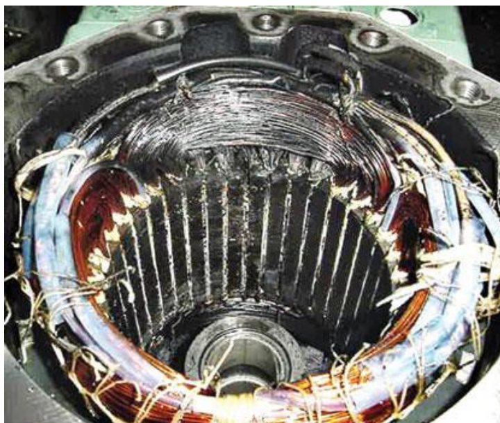
Рисунок 1.7 - Зображення пошкодження, викликаного коротким замиканням
