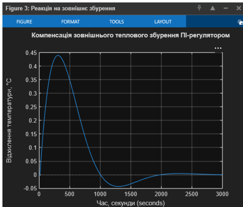
Рисунок 2.5 – Реакція САК на зовнішнє теплове збурення
