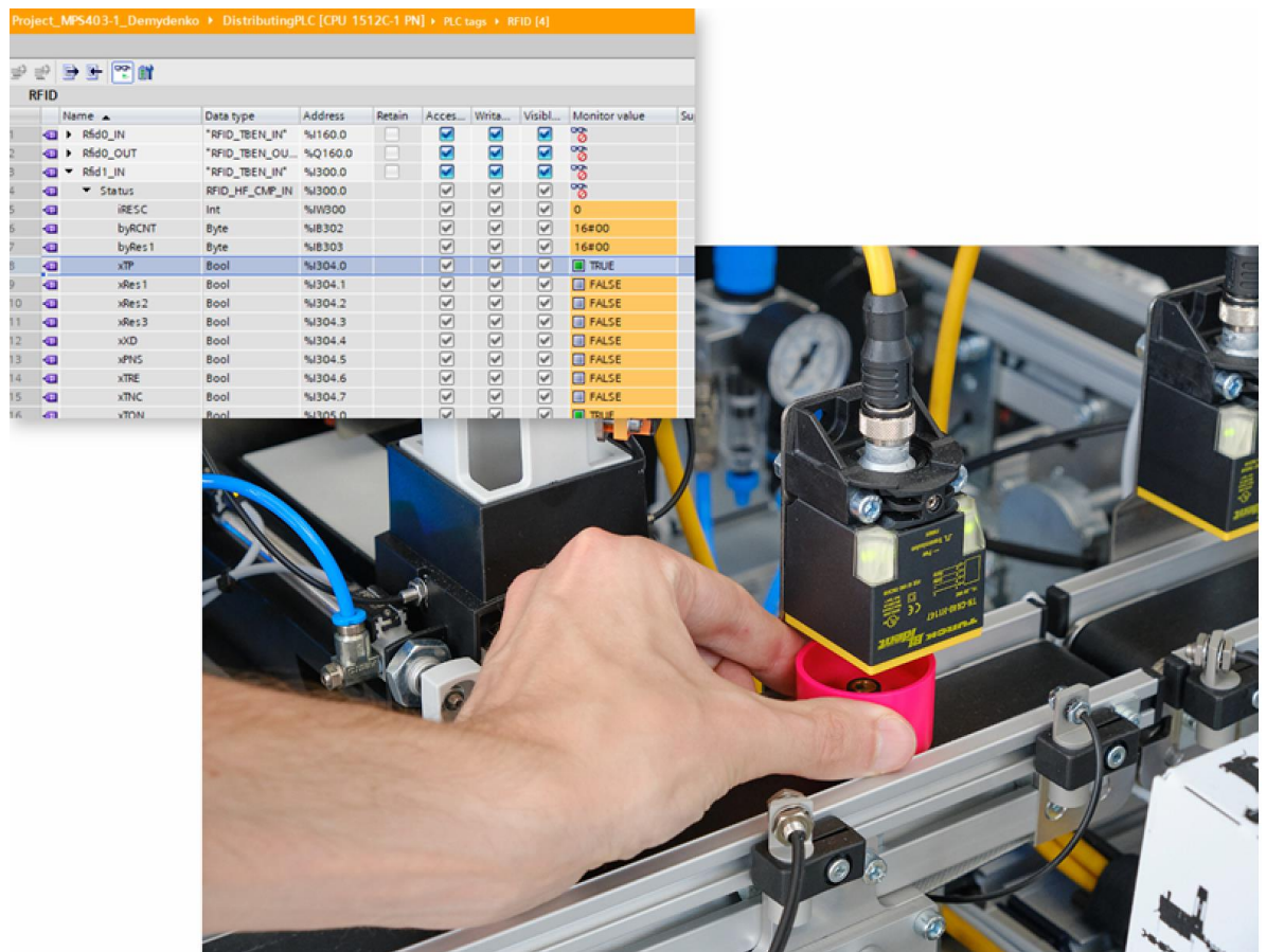
Рисунок 2.18 - Сигнал Tag Present (xTP) = TRUE: транспондер (мітка) у зоні зчитувача, транзакція ідентифікації активна
