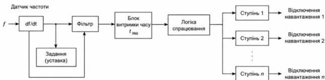
Рисунок 1.4 Схема автоматичного частотного розвантаження (АЧР)
