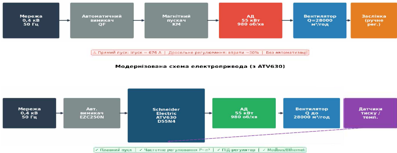
Рисунок 1.2 — Структурні схеми електропривода вентиляційної установки: існуюча (зверху) та модернізована (знизу)
