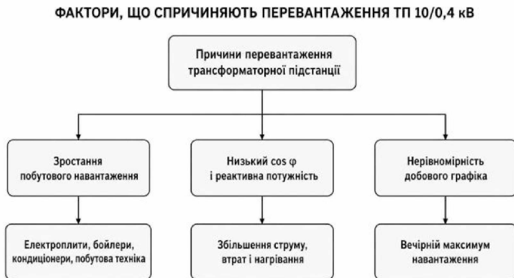
Рисунок 1.1 – Фактори, що спричиняють перевантаження ТП 10/0,4 кВ
