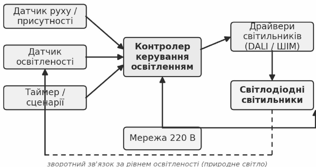
Рисунок 1.5 — Узагальнена структурна схема системи автоматичного керування освітленням (датчики — контролер — драйвери світильників)
