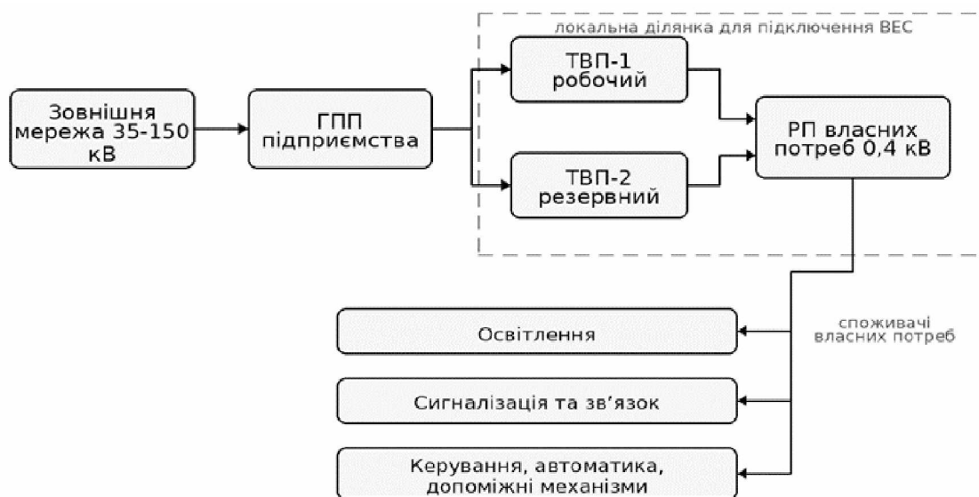
Рисунок 1.1 – Узагальнена структура електропостачання власних потреб ГЗК
