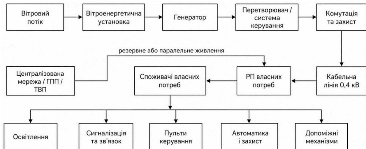
Рисунок 1.3 – Структурна схема використання ВЕС як локального джерела електроживлення власних потреб ГЗК
