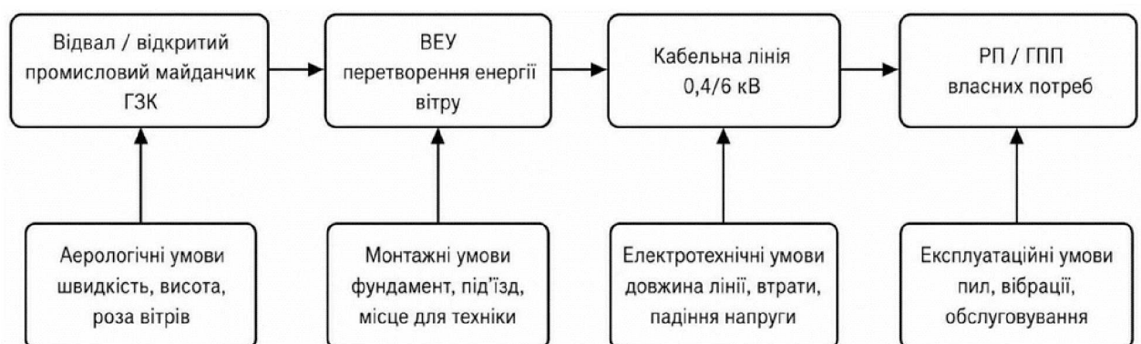
Рисунок 1.4 – Узагальнена схема вибору місця розміщення ВЕУ в системі власних потреб ГЗК
