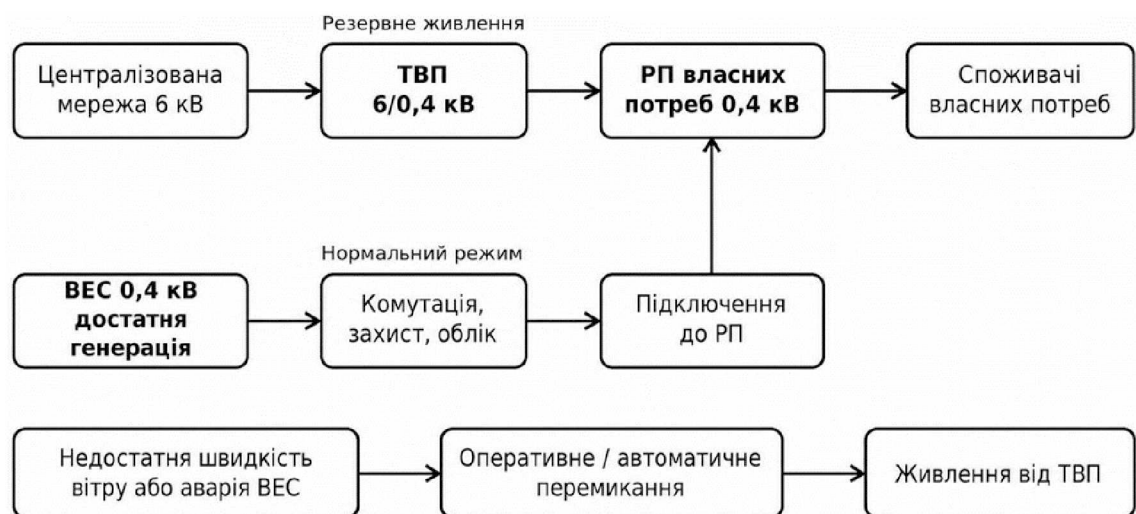
Рисунок 2.1 – Режими живлення власних потреб після впровадження ВЕС
