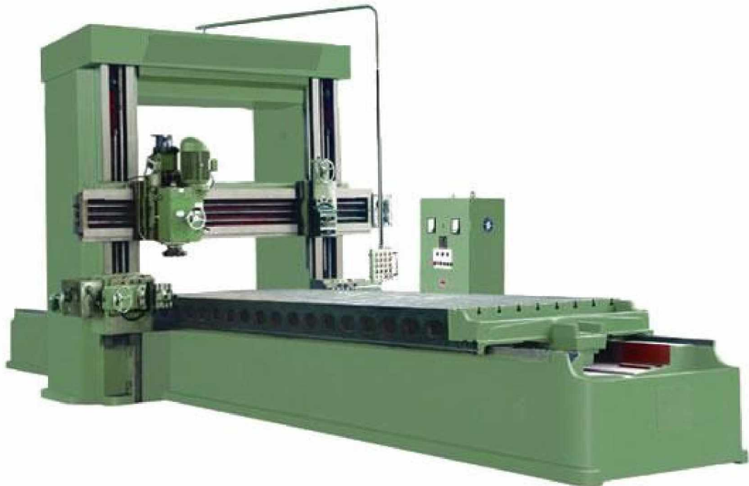
Рис.1.1 Загальний вид стругально-фрезерного верстата 7Б110.
