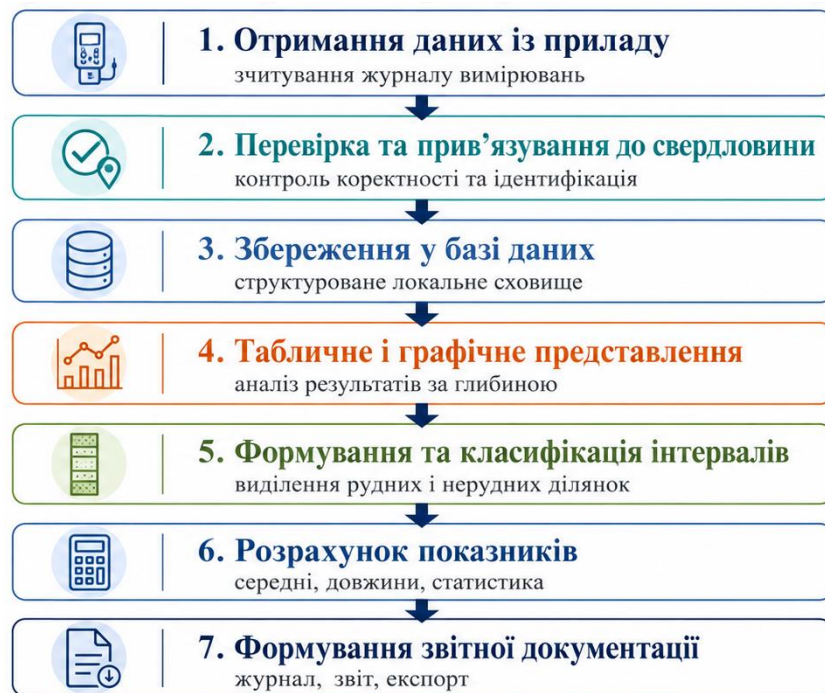
Рисунок 1.3 – Узагальнена схема камеральної обробки результатів вимірювань
