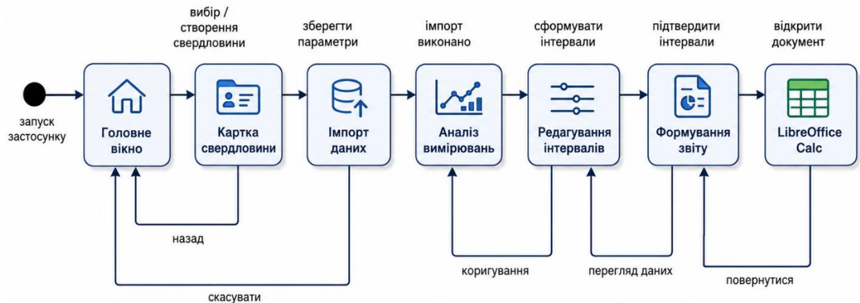
Рисунок 2.11 – UML-діаграма переходів між вікнами застосунку
