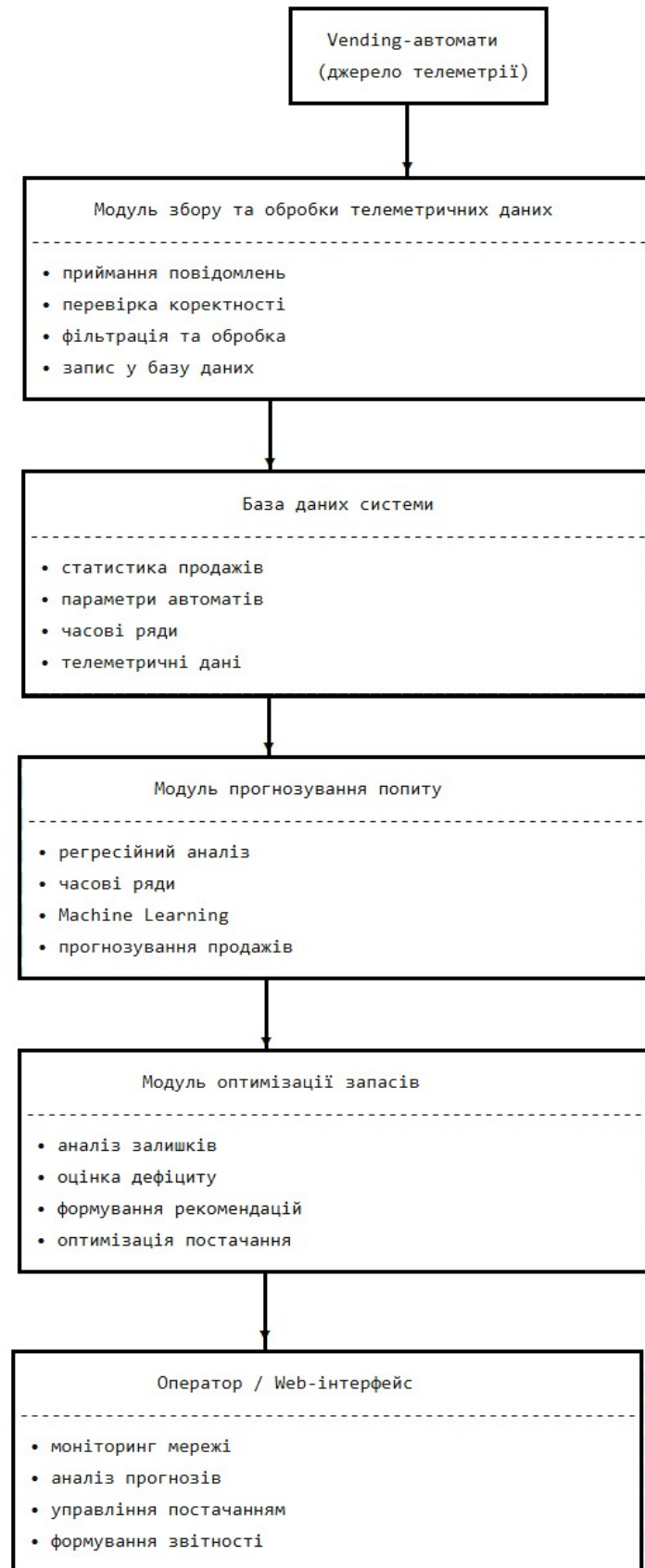
Рисунок 2.5 - Структурна схема взаємодії модулів інформаційно-аналітичної системи
