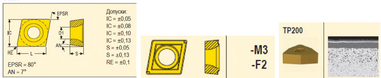
Рисунок 3.3 – Пластина Seco CCMT120408-F2; CVD покриття TP200 [1, с.423]: L=12мм, S=4мм, RE=0,8мм
