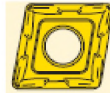
Рисунок 3.4 – Пластина Seco CCMT120408-MF2; CVD покриття TP1501 [1, с.423]: L=12мм, S=4мм, RE=0,8мм
