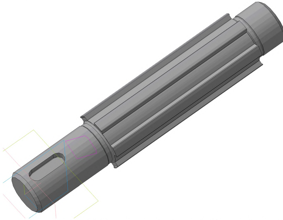
Рисунок 1.1 – Об'ємна модель деталі «Вал шліцьовий»
