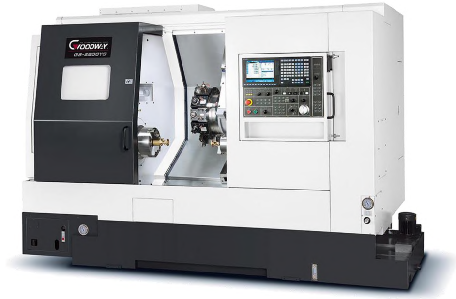
Рисунок 5.1 – Багатоцільовий токарний верстат Goodway серії GS-2000
