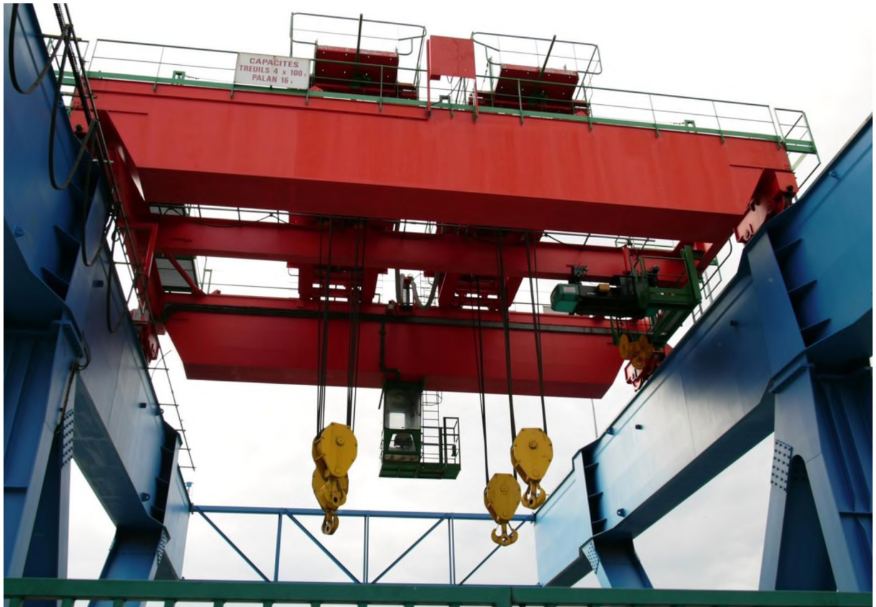
Рисунок 1.2 – Загальний вигляд мостового крану
