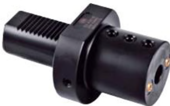
Рисунок 3.14 – Різцетримач розточний 30x40 тип C2 [7, с. 5.12]: d1=30 ; d2=40 ; A=90 ; L3=22 ; h1=32 ; h=30 ; d3=66 ; d6=68
