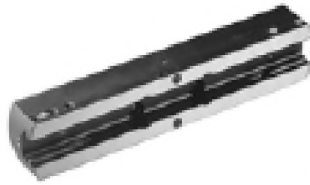
Рисунок 3.3 – Загальний вид траверси для розточки
