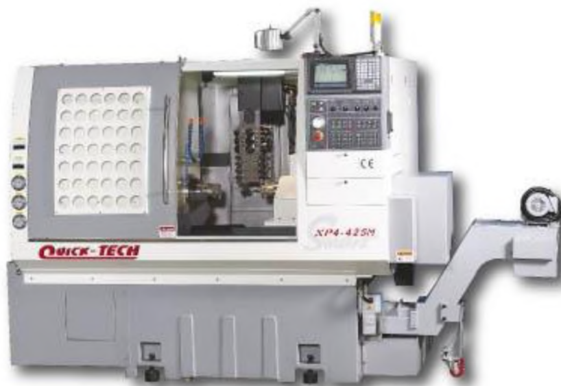
Рисунок 2.3 – Токарно-фрезерний верстат із ЧПК QUICK-TECH LT3-200S
